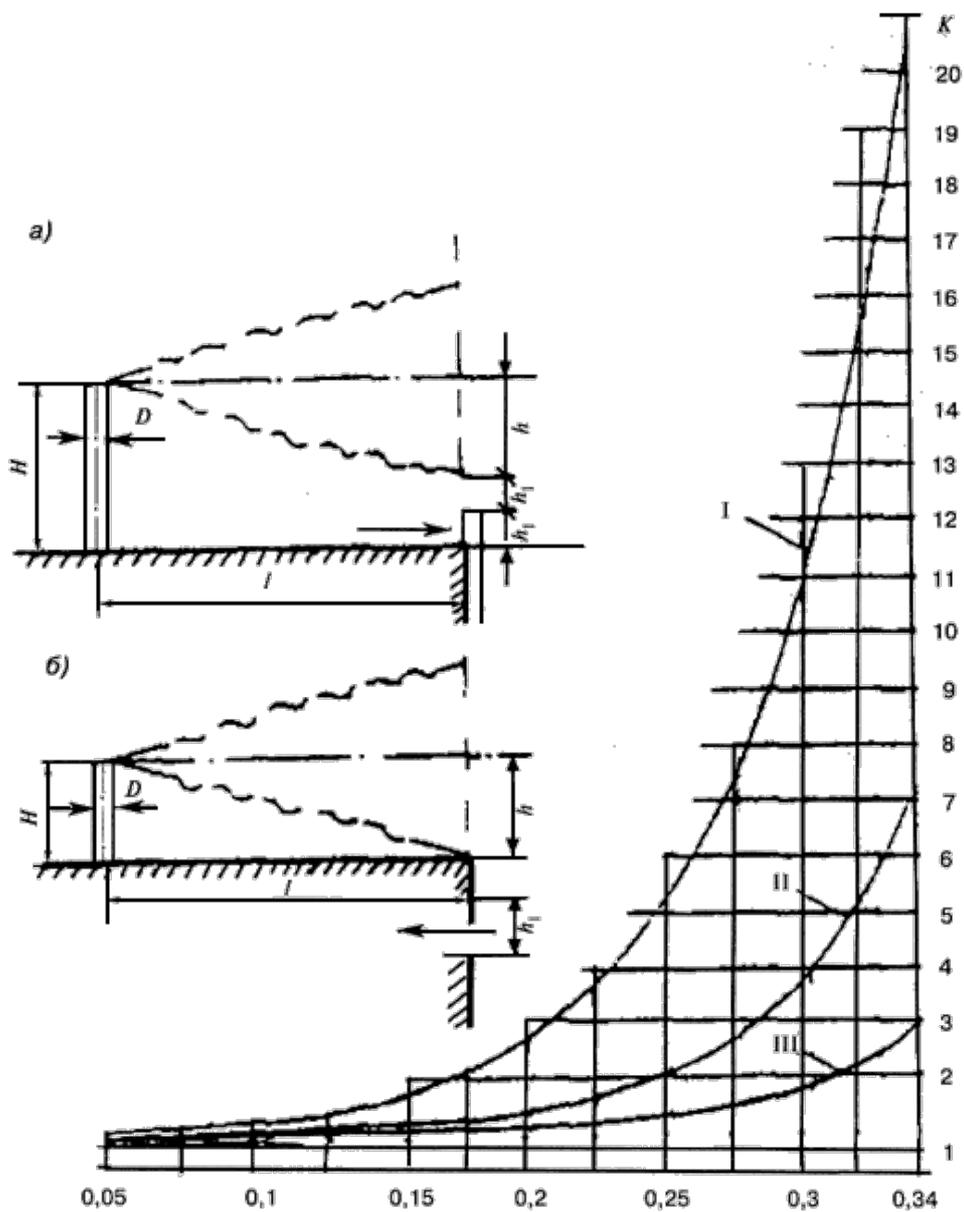
а - расположение источника над зоной всасывания наружного воздуха приемным устройством (высота трубы источника  $H = 2h_1 + h$ ); б - то же, над кровлей здания (высота трубы источника  $H = h$ );
